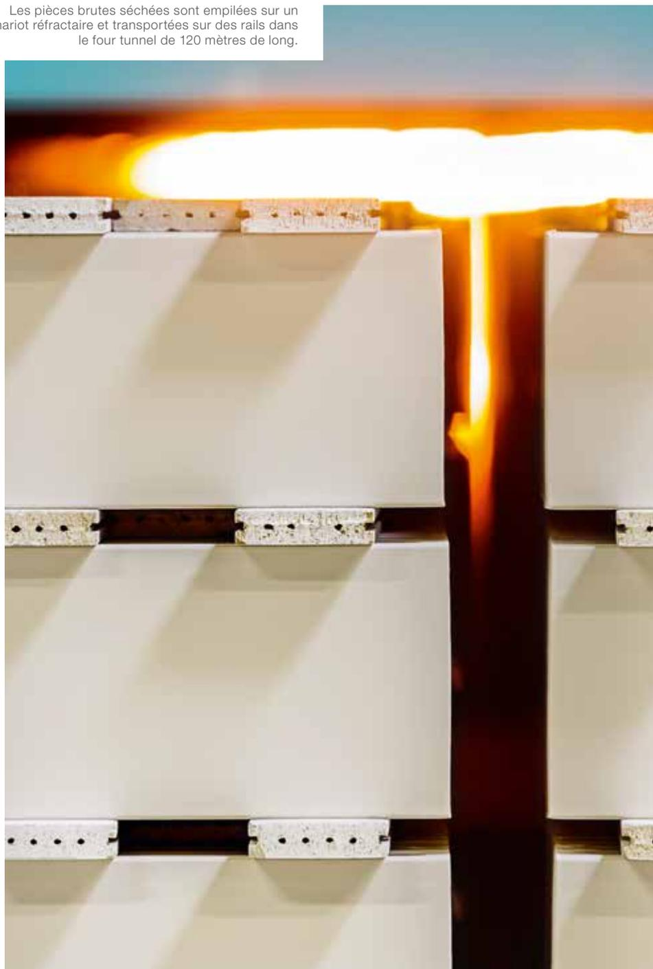
Lors de la dernière étape de fabrication, les deux carreaux accrochés l'un à l'autre sont séparés au niveau des points de rupture des entretoises.
